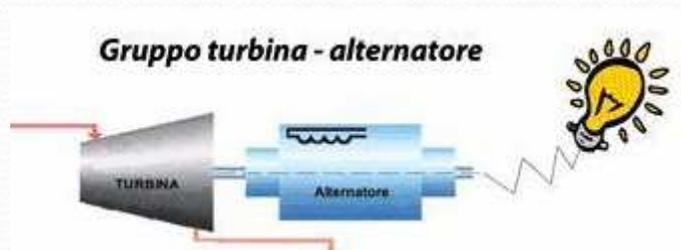
Nel gruppo turbina l'energia termica del vapore viene convertita dalla turbina in energia meccanica. L'energia meccanica derivante dalla turbina viene convertita in energia elettrica dall'alternatore
