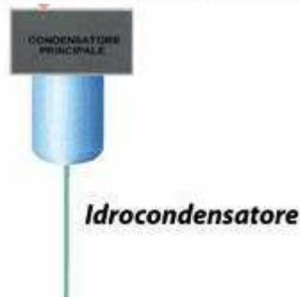
Il vapore che ha alimentato la turbina, nell'idrocondensatore, viene condensato e riportato allo stato liquido.
