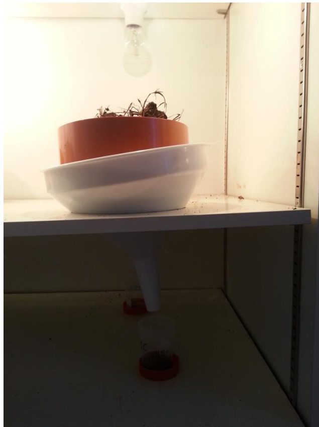
Fig.3 –Particolare dell'estrattore Berlese-Tullgren
