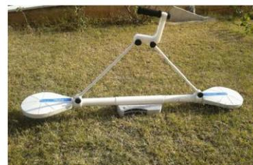
Il dispositivo trasmittente crea un campo elettromagnetico "primario" che induce nel terreno una corrente elettrica direttamente proporzionale alla conducibilità dello stesso. Questa corrente crea un campo elettromagnetico "secondario", proporzionale alla corrente indotta, che viene rilevato dal ricevitore.
