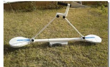
Il dispositivo trasmittente crea un campo elettromagnetico "primario" che induce nel terreno una corrente elettrica direttamente proporzionale alla conducibilità dello stesso. Questa corrente crea un campo elettromagnetico "secondario", proporzionale alla corrente indotta, che viene rilevato dal ricevitore.
