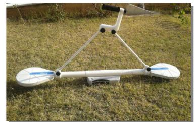
Il dispositivo trasmittente crea un campo elettromagnetico "primario" che induce nel terreno una corrente elettrica direttamente proporzionale alla conducibilità dello stesso. Questa corrente crea un campo elettromagnetico "secondario", proporzionale alla corrente indotta, che viene rilevato dal ricevitore.
